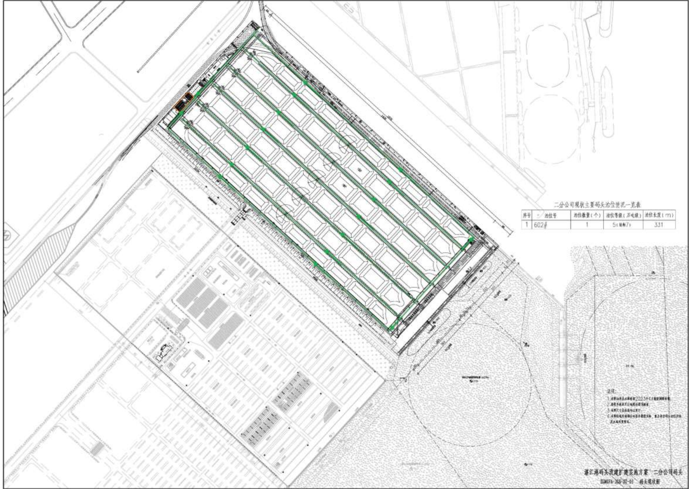
图 3.4-1 现有项目雨污水管网图
